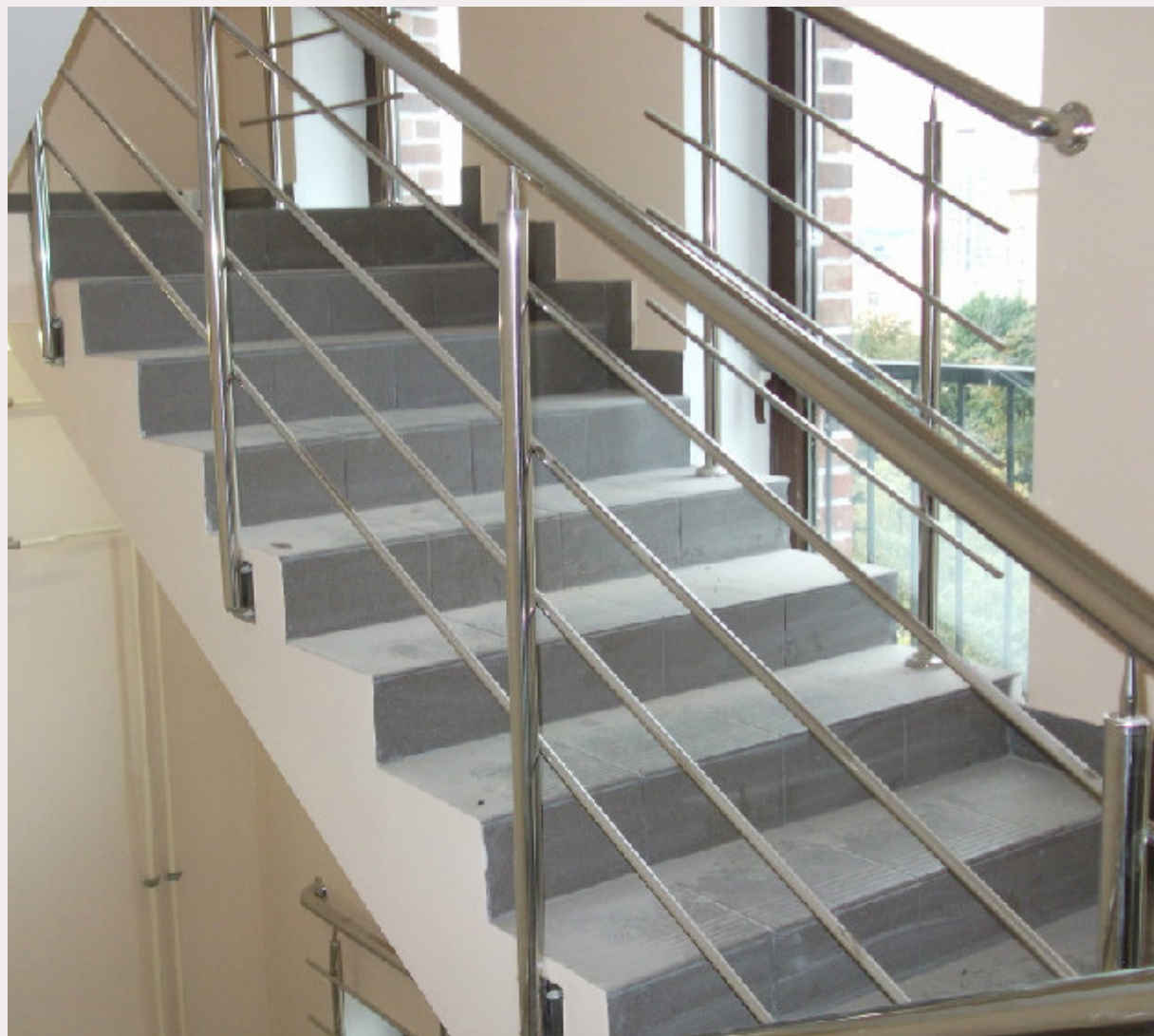
объект: ЖК Трилогия материал: нержавеющая сталь поручень Ф 51 мм стойки Ф 38 мм заполнение: ригель 16 мм, три ряда крепление: сбоку марша
